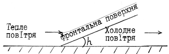
Мал. 6.19. Вертикальний розріз фронтальної поверхні
