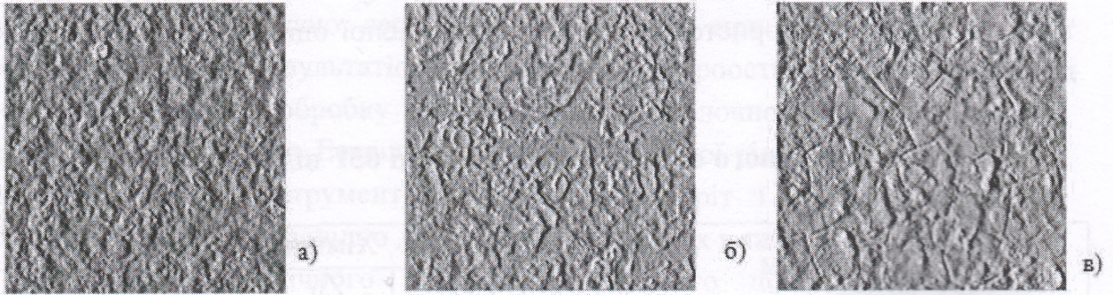
Рис. 2. Шорсткість центру поверхні зразків після електроерозійної обробки в максимальному (а) середньому (б) і мінімальному (в) режимах.
