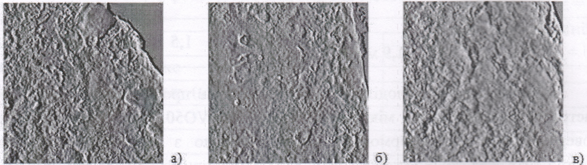
Рис. 3. Шорсткість краю поверхні зразків після електроерозійної обробки в максимальному (а), середньому (б) і мінімальному (в) режимах.
