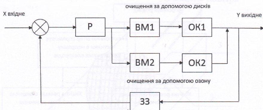
Рис. 7. Структурна схема вологого очищувача повітря з розподілом по типу очищення
