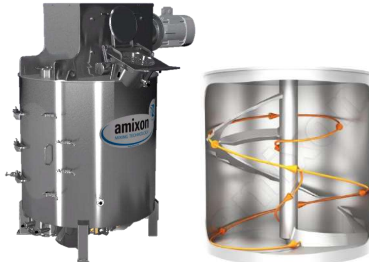
Рис. 5. Вертикальний одновальний стрічковий змішувач та схема циркуляції продукту
