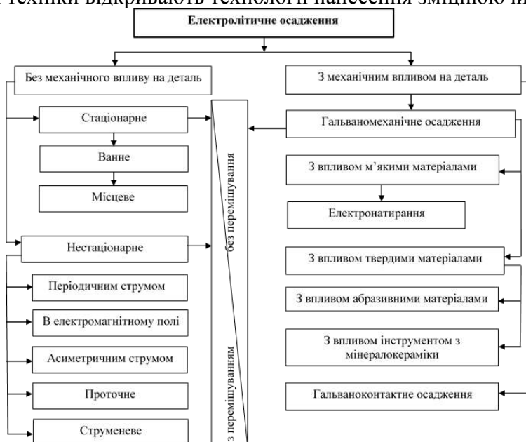
Рис. 1. Способи відновлення деталей електроосадженням.
