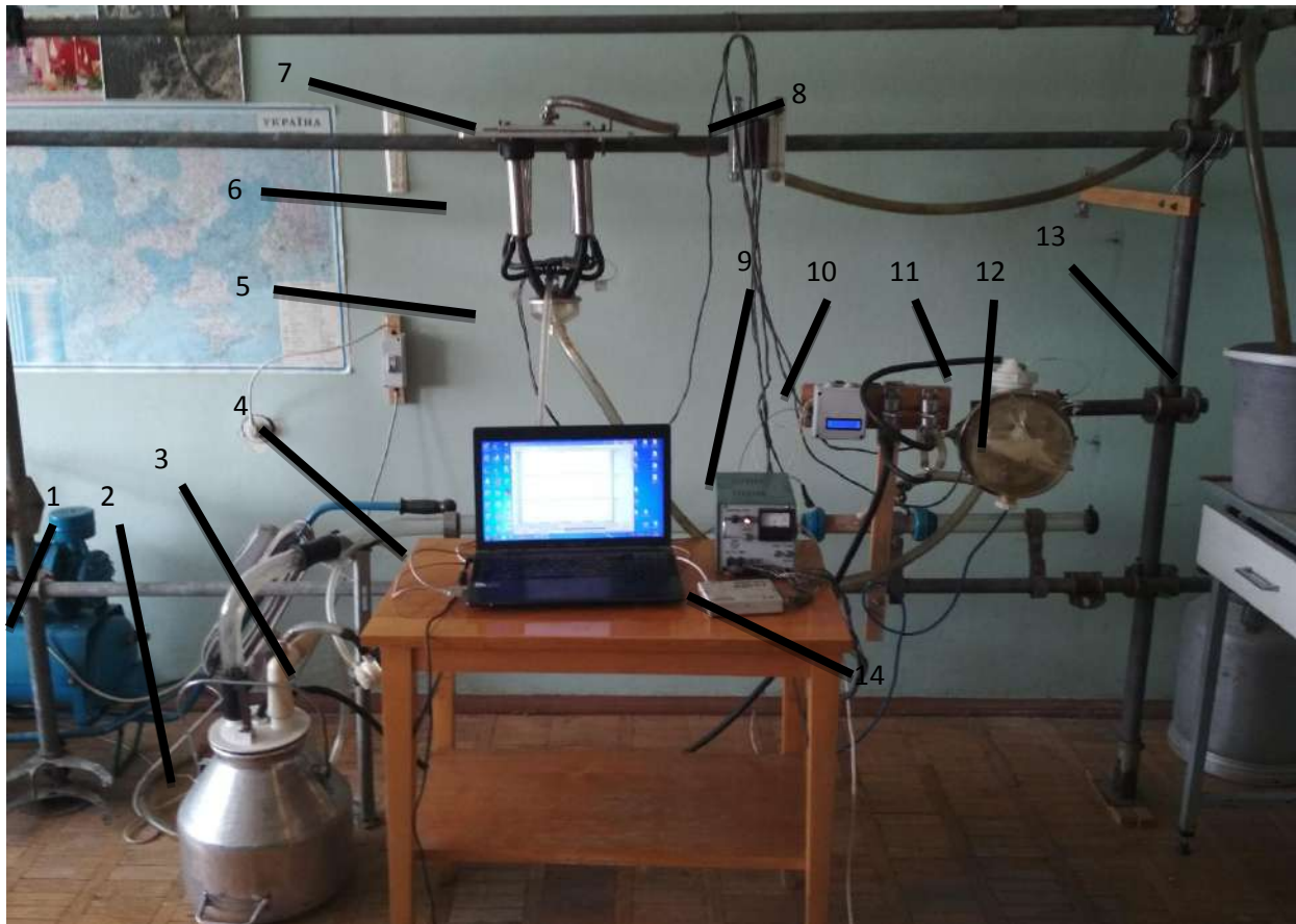
Рис. 1. Загальний вигляд лабораторного стенду: 1 – вакуумна установка; 2 – бідон для збору молока; 3 – пульсатор; 4 – комп’ютер; 5 – колектор; 6 – доїльні стакани; 7 – штучне вим’я; 8 – ротаметр FM-02; 9 – блок живлення типу АГАТ; 10 – блок керування процесом доїння; 11 – регулятор вакууму мембранного типу; 12 – ковшовий лічильник; 13 – ємність з молоком; 14 – аналоговий цифровий перетворювач Е14-440.
