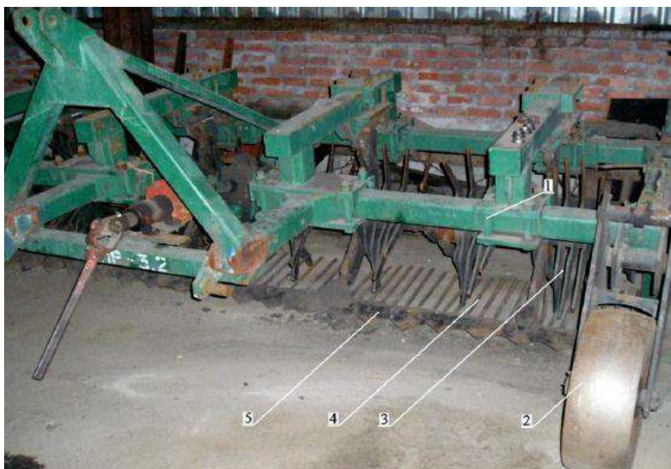
Рис. 1. Машина для обробки орного шару ґрунту: 1 – рама; 2 – опорні колеса; 3 – ротор; 4 – сепаруюча решітка; 5 – леміш
