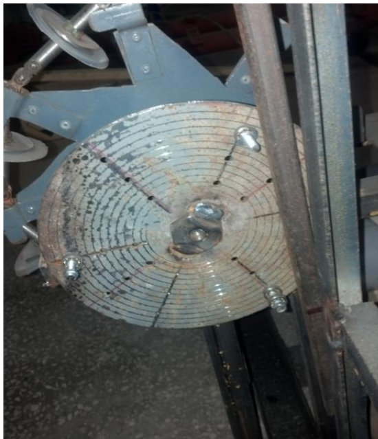
Рис. 3.5. Привідний обертовий диск процесу сепарації та транспортування сипких матеріалів
