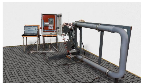
Рис. 1.7. Експериментальна установка трубчастого скребкового конвеєра переміщення сипкого середовища
