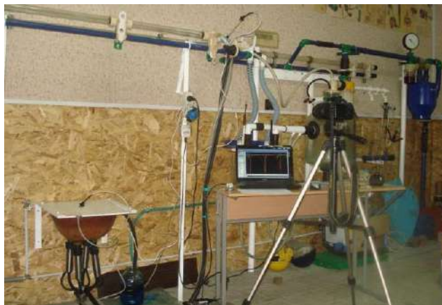
Рис. 1. Загальний вид експериментального стенду доїльної установки із доїльним апаратом одночасної дії при підключенні його до верхнього молокопроводу
