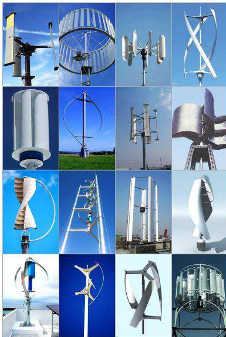
Рис. 1. Види вітроенергоустановок з ВВО.
