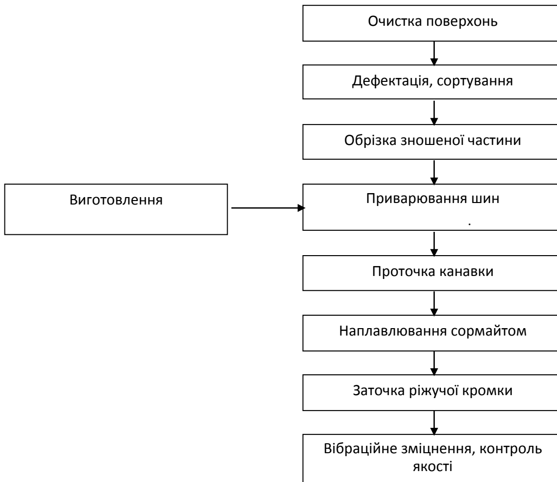
Рисунок 1 - Технологічна схема відновлення і зміцнення лемешів
