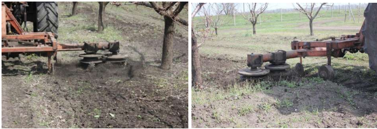
Рис. 3. Обробіток ґрунту в пристовбурній смугі фрезерною машиною МФ-1М з експериментальними робочими органами
