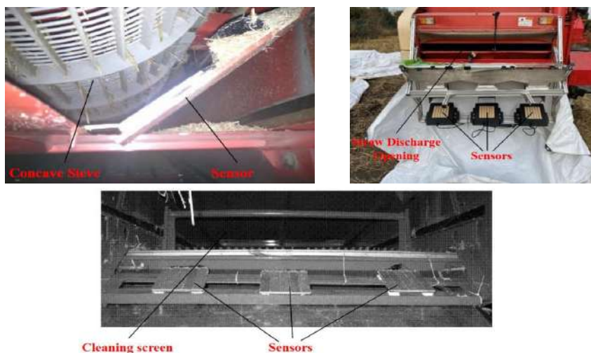
Рис. 2. Різні положення установки датчиків на комбайні.
