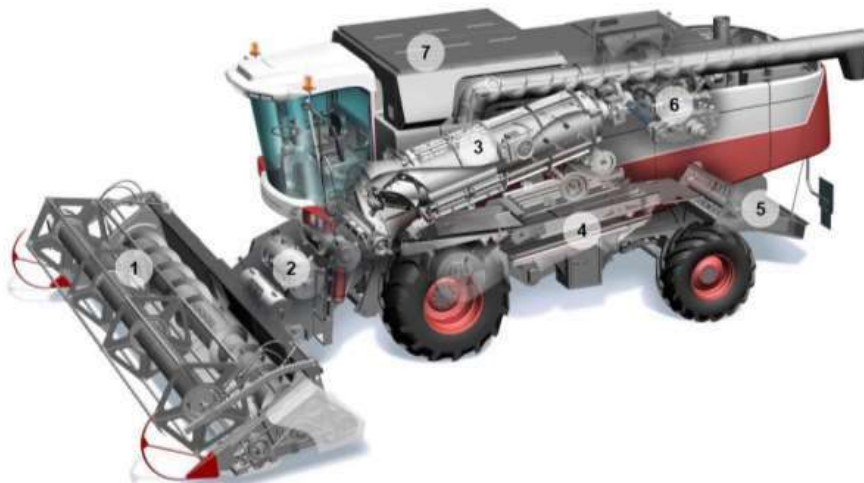
Рис. 2. Загальний вигляд зернозбирального комбайна "Togun 740" з аксіально-роторним МЗК: 1 – жатка; 2 – похила камера; 3 – роторна молотильна система; 4 – система очищення; 5 – подрібнювач-розкидач; 6 – силова установка; 7 – бункер.
