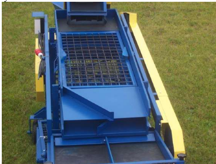
Рис. 13. Машина для сортування картоплі з рухомих решето
