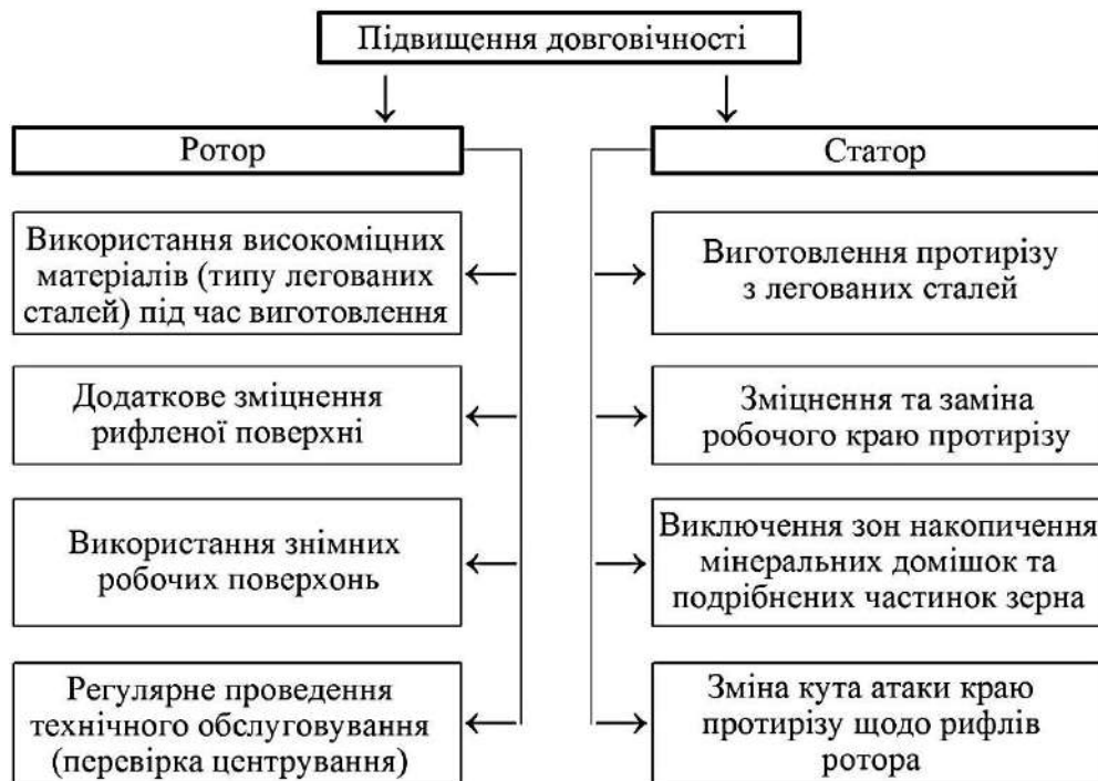
Рис. 2. Способи підвищення довговічності ротора та статора зернодробарки
