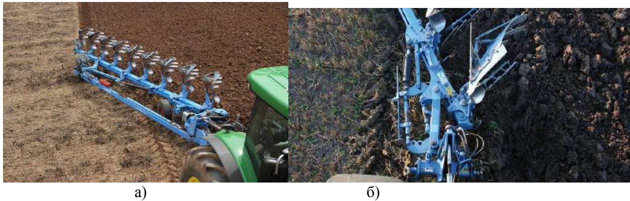
Рис. 1. - Напівнавісний плуг плуг Lemken Diamant 12 виконаний за схемою з опорою на колесо
