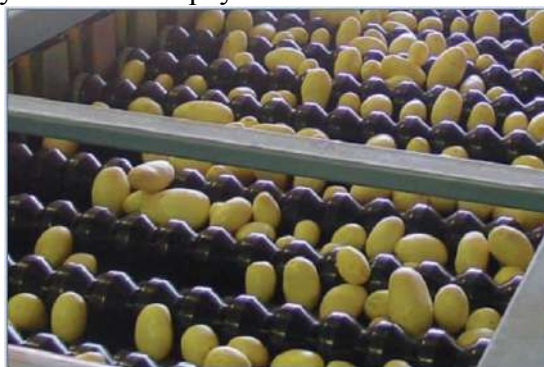
Рис. 7. Калібрування картоплі фасонними роликами
