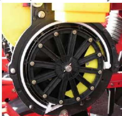
Рис. 11. Висівний апарат зі струшувачем насіння
