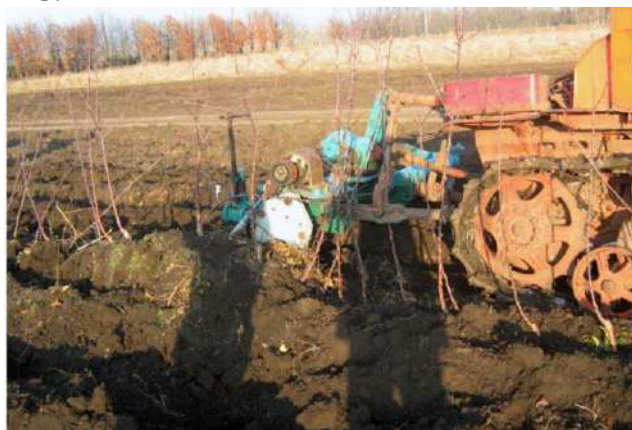
Рис 1. Викопування саджанців яблуні плугом ВПН - 2М з експериментальним робочим органом
