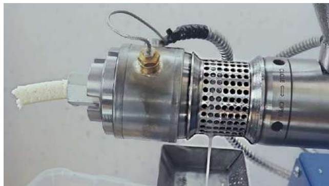
Рис. 5. Зеєрна камера шнекового преса: а – регулювання зазору між зеєрними пластинами за допомогою спеціальних припливів; б – регулювання зазору між зеєрними пластинами за допомогою шайб
