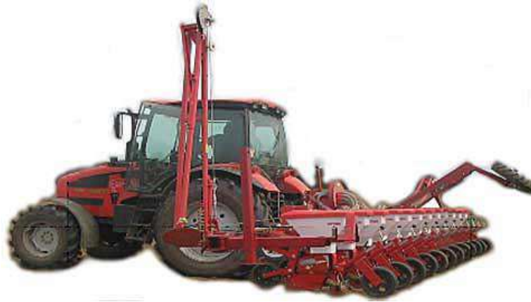
Рис. 4. Сівалка бурякова пневматична причіпна широкозахватна СКПП-12 Сівалка СКПП-12 в 1,8 разу продуктивніша за сівалку СУПН-8 і забезпечує:
