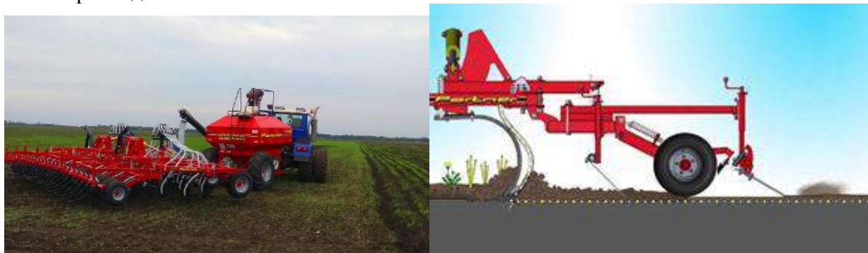
Рис. 1. Сівалка для безрядної сівби, обладнана експериментальними сошниками
