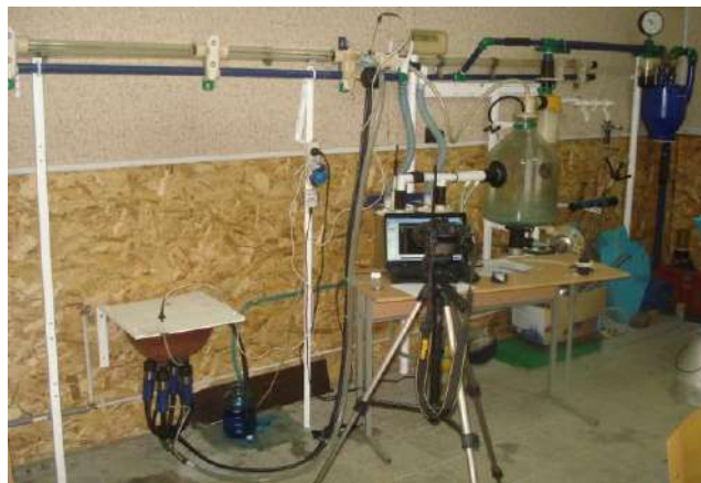
Рис. 2. Загальний вид експериментального стенду доїльної установки із доїльним апаратом попарної дії при підключенні його до верхнього молокопроводу
