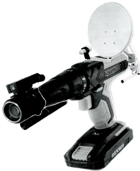
Рис. 2. Лазерна система аналізу газових сумішей.
