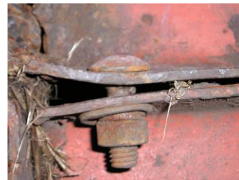
Рисунок 2 - Болт М12 кріплення секції подрібнювального апарата деформований розтягом надмірним осьовим зусиллям
