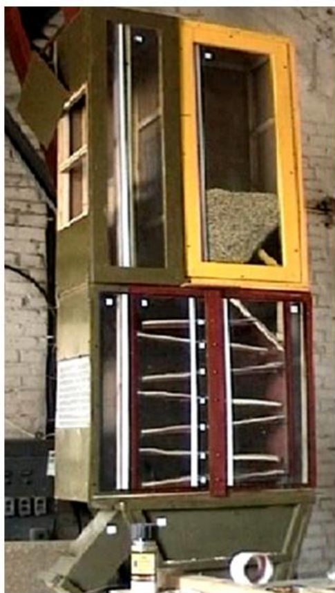
Рис. 1 – Зерносушарка з киплячим шаром (фото експериментального взірця)
