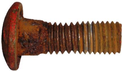
Рисунок 1 - Болт М12 кріплення боковини секції молотильного апарата деформований розтягом надмірним осьовим зусиллям
