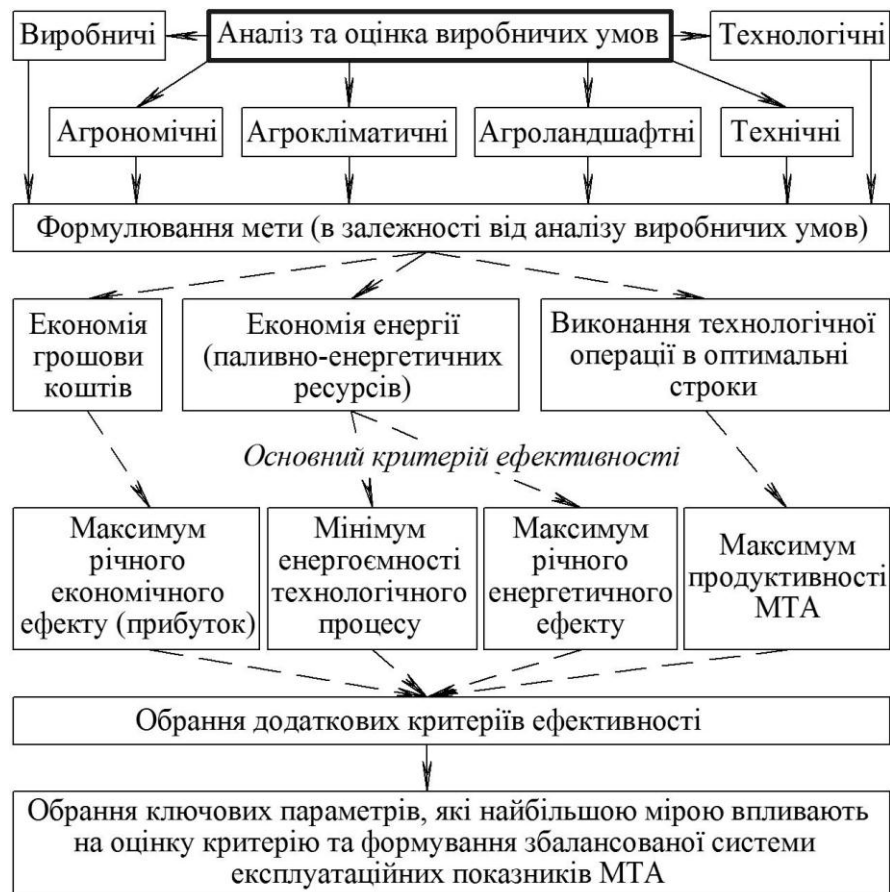
Рис. 1. Схема вибору критеріїв ефективності використання мобільних транспортних засобів
