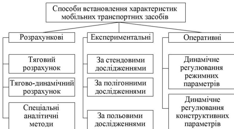
Рис. 2. Підходи до встановлення характеристик мобільних транспортних засобів та їх агрегатів
