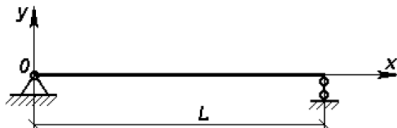
Рисунок 1. Схема шарнірного закріплення щітки просіювача у вигляді суцільного однорідного стрижня.
