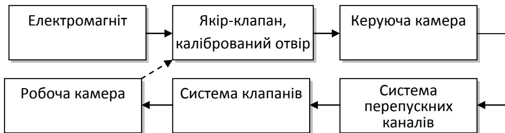
Рисунок 2 – Функціональна модель пневмоелектромагнітного пульсоколлектора доїльного апарату
