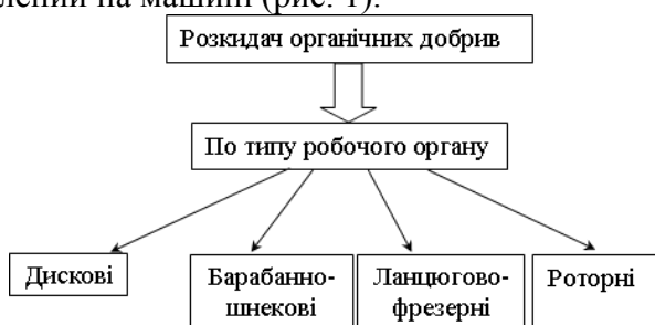
Рис. 1. Класифікація розкидачів органічних добрив по типу розподільчого органу
