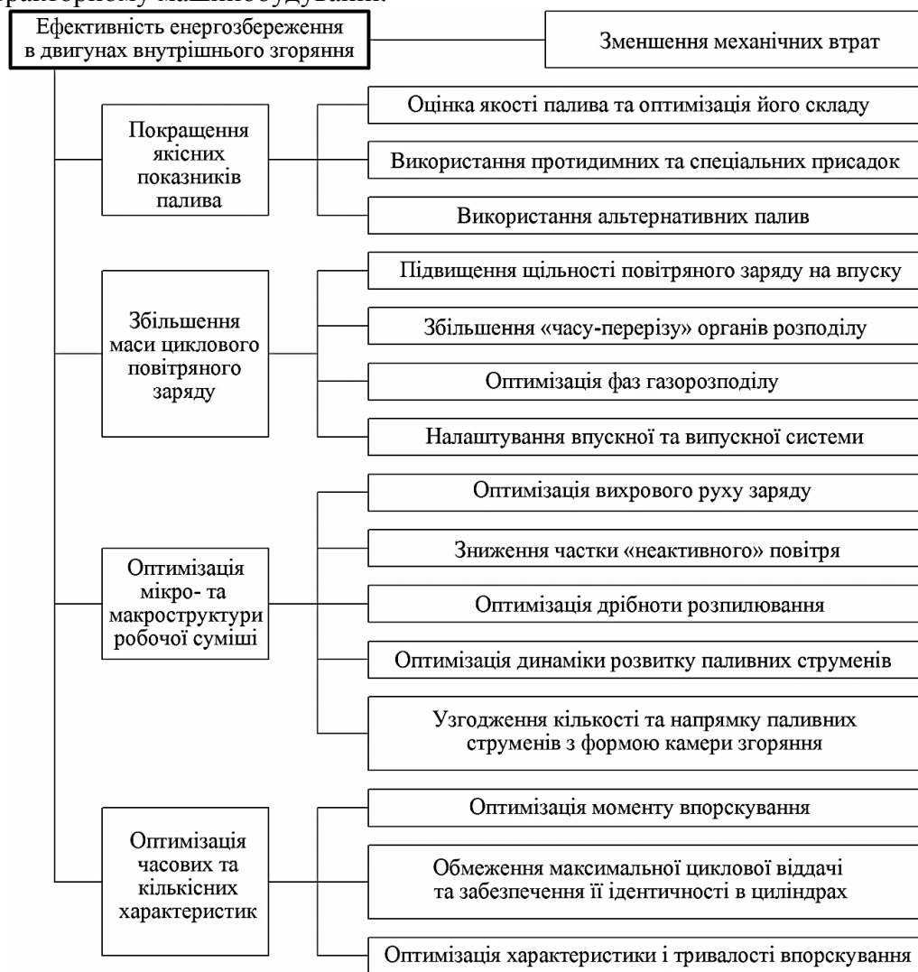
Рис. 1. Структурна схема підвищення ефективності енергозбереження в автотракторних двигунах
