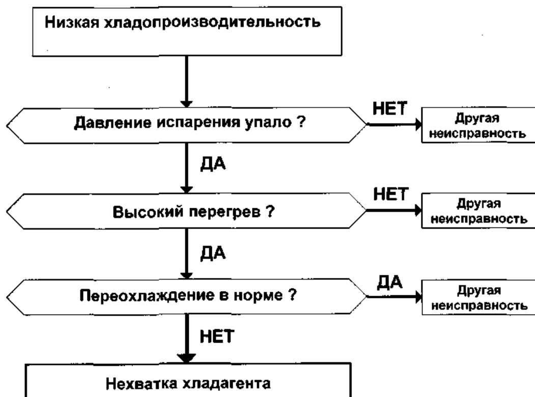
Рисунок 2 Алгоритм диагностирования недостатка хладагента
