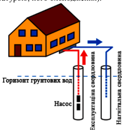
Рис. 1. Схема відкритої системи використання низькопотенційної теплової енергії ґрунтових вод
