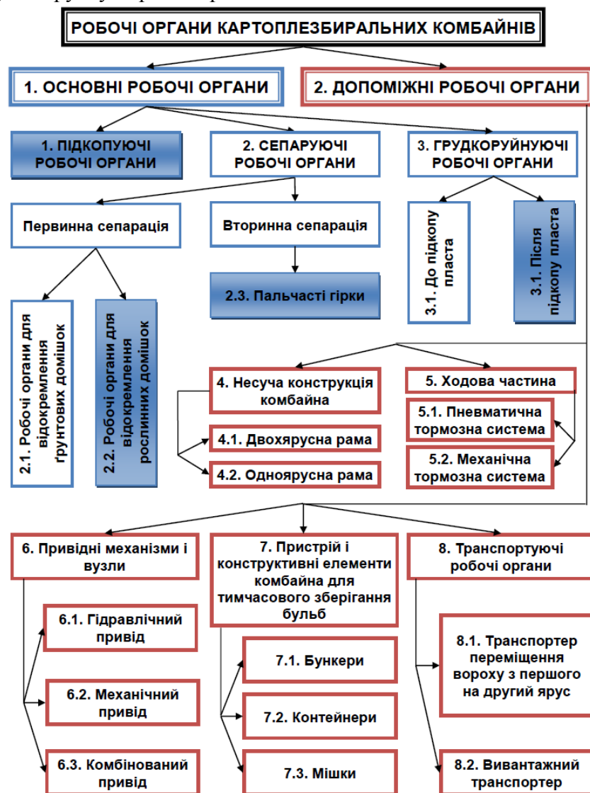
Рис. 1. Класифікація робочих органів і вузлів картоплезбиральних машин – перспективні напрямки вдосконалення робочих органів
