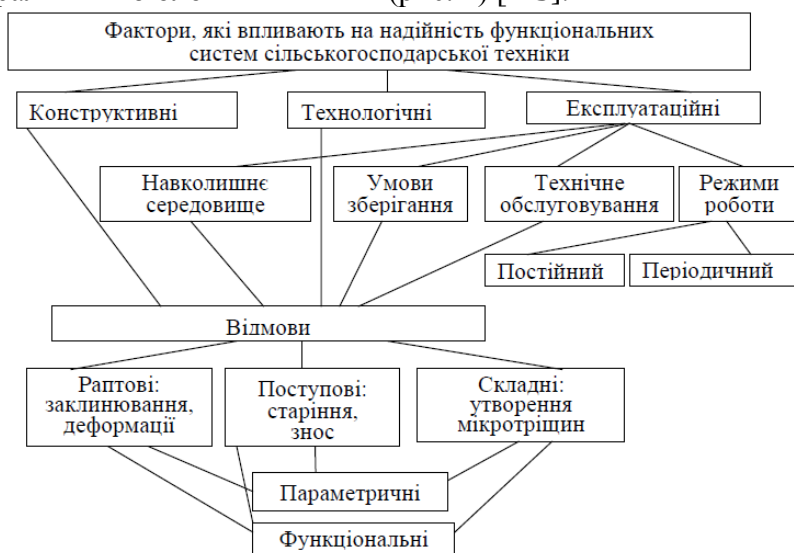
Рис. 1. Блок-схема основних факторів, які впливають на надійність функціональних систем сільськогосподарської техніки
