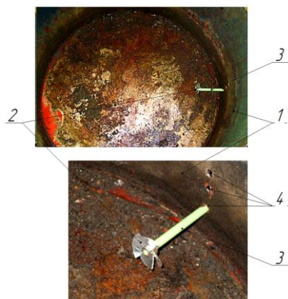
1 – емкость, 2 – мешалка, 3 – вал, 4 – регулировочные окна
