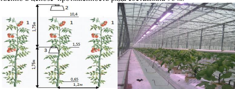
Рис. 1. Расположение светодиодных светильников в светокультуре томата: 1— растения томата (рассада); 2 —облучатели, расположенные над ценозом (175 Вт), 3 — нижний ряд облучателей (175 Вт).
