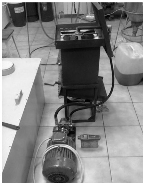
Рис. 2. Експериментальна установка для виробництва дизельного біопалива з використанням гідрореактивного перемішування
