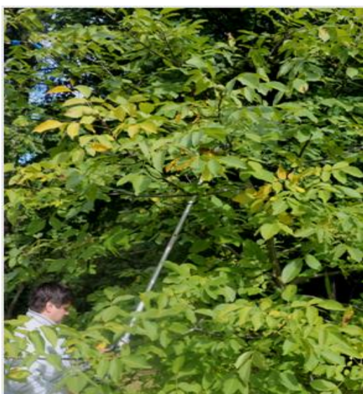
Рис. 1. Модернізований ручний віброударний струшувач під час знімання горіхів
