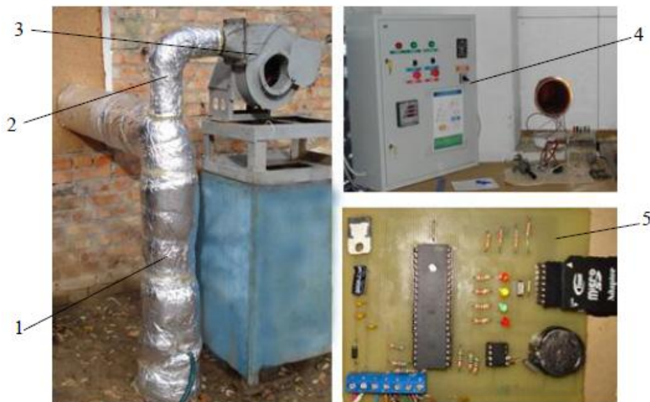
Рис. 1. Експериментальна установка: 1 – обсадна труба ґрунтового теплообмінника; 2 – нагнітальний повітропровід; 3 – відцентровий вентилятор; 4 – частотний перетворювач Danfoss VLT Micro Drive M3; 5 – багатоканальний пристрій моніторингу температури
