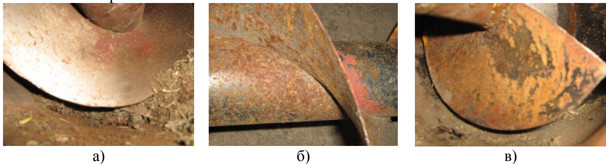
Рис. 1. Робочі поверхні гвинта шнекового живильника ОВС-25, термін зберігання після експлуатації:
