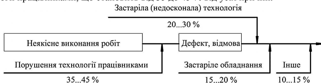
Рис. 2. Причинно-наслідкова діаграма якісного виконання сервісних робіт
