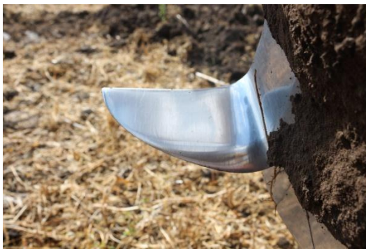
Рис. 1. Типова поверхня тертя РО ГМ (робочий орган фірми Bednar FMT, напрацювання агрегату 130 га, Попільнянський район, Житомирської області).
