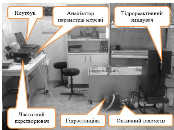
Рис. 1. Експериментальна установка для виробництва дизельного біопалива з вимірювальним обладнанням
