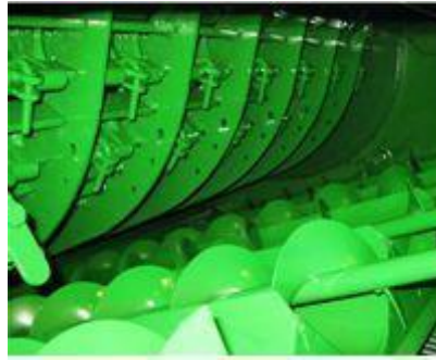
Рис. 2. Підбарабання з вкладишами.
