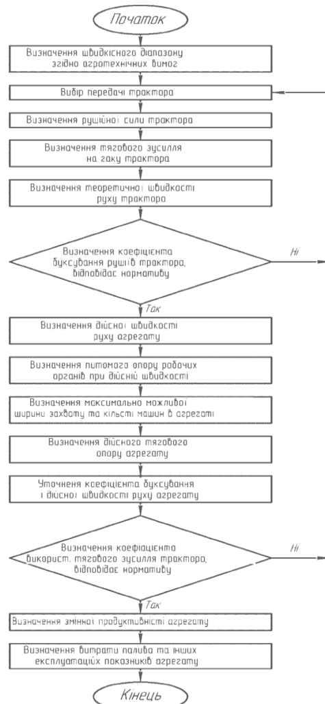
Рис. 1. Алгоритм розрахунку техніко-експлуатаційних показників агрегатів.
