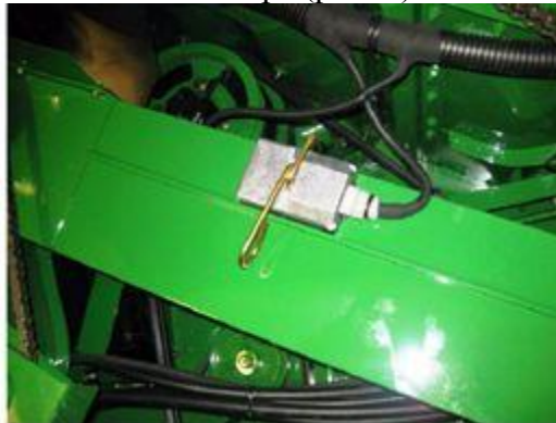
Рис. 4. Лазерний датчик на корпусі елеватора.
