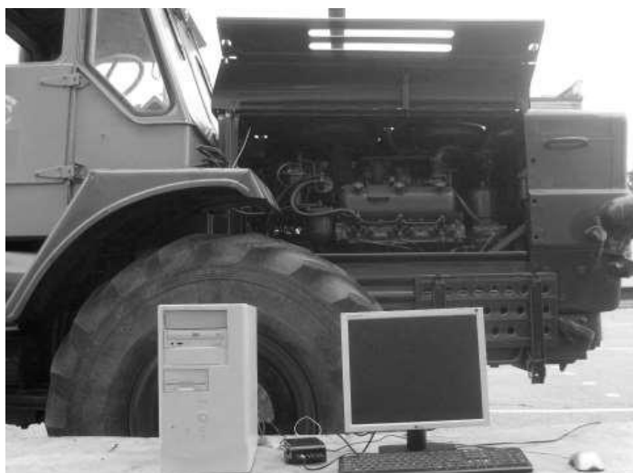
Рис. 2. Діагностичний комплекс, підготовлений до роботи
