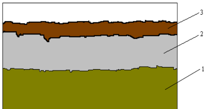
Рисунок 1 – Расслоение жидкого навоза на фракции: 1-нижний слой; 2-средний слой (жидкая фракция); 3-верхний слой (поверхностная корка)
