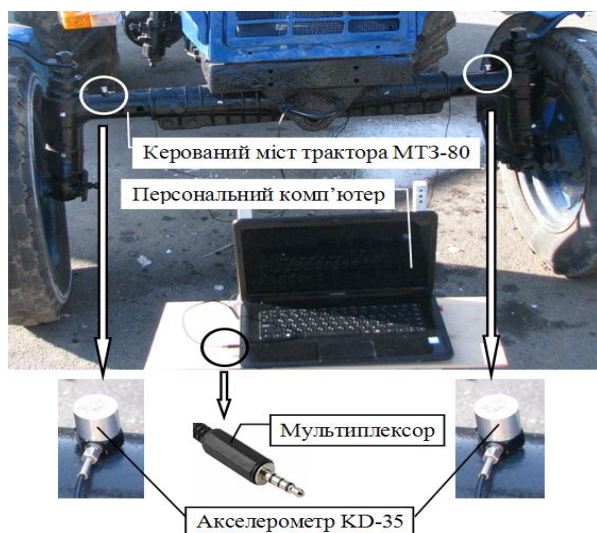
Рисунок 1 – Система діагностування керованих мостів колісних сільськогосподарських тракторів: а – загальний вигляд; б – структурна схема; 1 – керований міст трактора; 2, 3 – акселерометри; 4 – мультіплексор; 5 – аналого-цифровий перетворювач; 6 – обчислюючий пристрій; 7 – монітор; 8 – друкуючий пристрій
