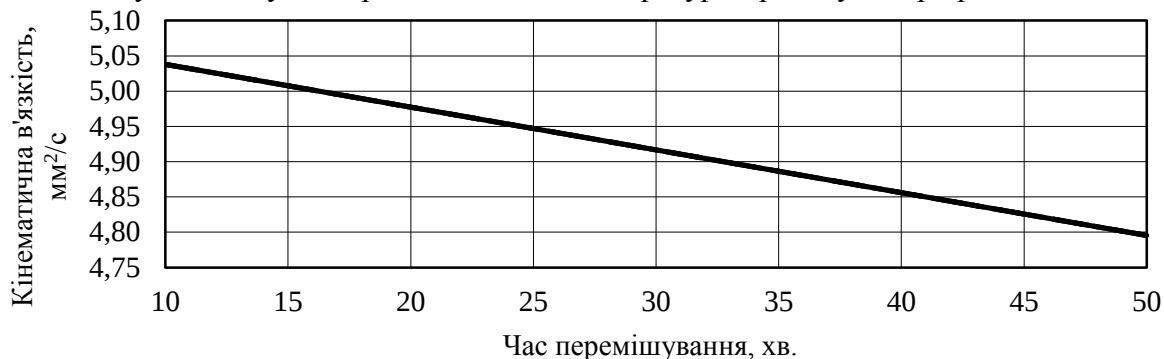
Рисунок 1 – Залежність кінематичної в'язкості дизельного біопалива від часу процесу естерифікації
