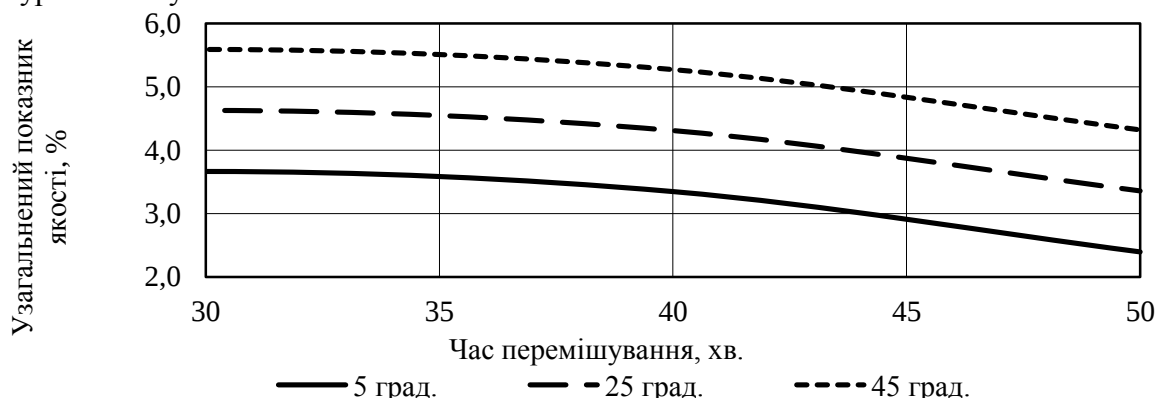
Рисунок 5 – Залежність узагальненого показника якості дизельного біопалива від часу перемішування та температури процесу естерифікації
