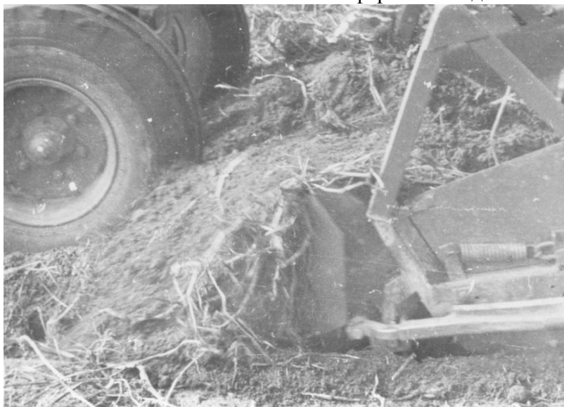
Рисунок 1 – Сгуживание подкопываемой грядки на лемехе картофелеуборочной машине
