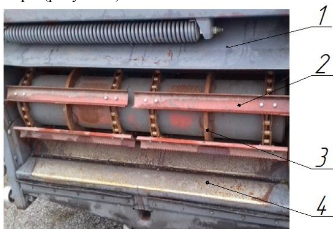
Рисунок 1 – Наклонная камера зерноуборочного комбайна: 1 - наклонная камера; 2 – планка цепочно-планчатого транспортера; 3 – стабилизирующее кольцо; 4 – рамка переходная
