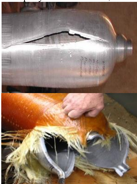
Рис. 1. Руйнування лейнерів комбінованих балонів
