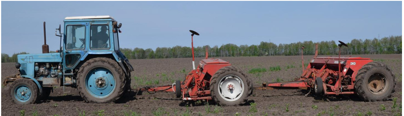
Рис.1. Двосівалковий агрегат для стрічкового внесення основних доз твердих мінеральних добрив, сівби сільськогосподарських культур та припосівного внесення добрив стартовими дозами
