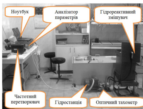
Рис.1. Експериментальна установка для виробництва дизельного біопалива з вимірювальним обладнанням
