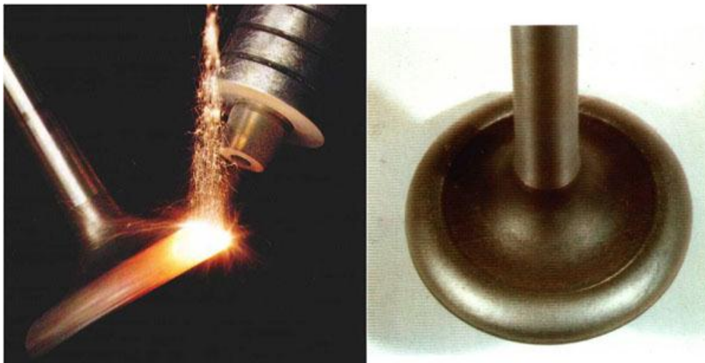
Рис. 2. Відновлення фасок клапанів автомобільного двигуна методом лазерного наплавлення
