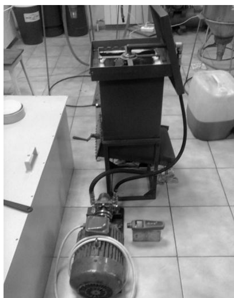
Рис.2. Експериментальна установка для виробництва дизельного біопалива з використанням гідромеханічного перемішування
