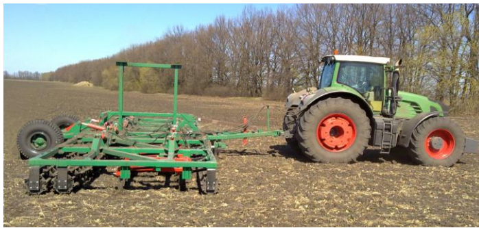
Рисунок 1 – Культиватор КВАНТ-12, укомплектований виготовленими і зміцненими робочими органами для проведення випробувань в польових умовах
