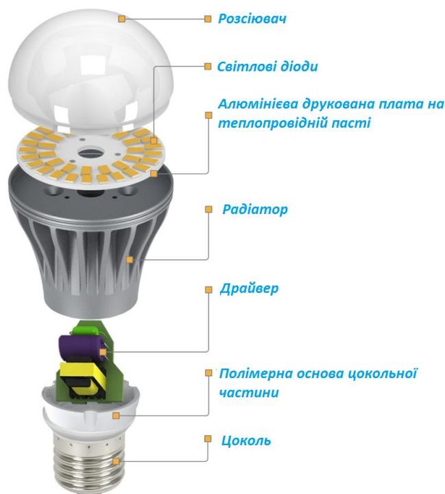
Рисунок 1.2 – Будова світлодіодної лампи
