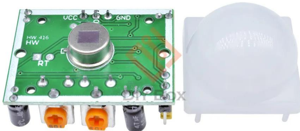
Рисунок 3.6 – Датчик руху HC SR501
