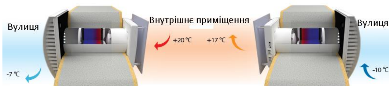
Рисунок 2.10 – Принцип рекуперації енергії повітря
