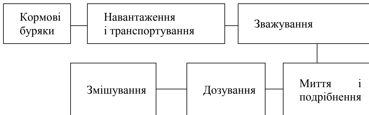
Рисунок 2.3 Структурна схема лінії коренеплодів
