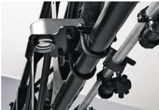
Рисунок 3.8. Ультразвуковий датчик, встановлений на штанзі обприскувача
