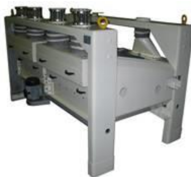
Рисунок 4.5-Загальний вигляд сепаратора.
