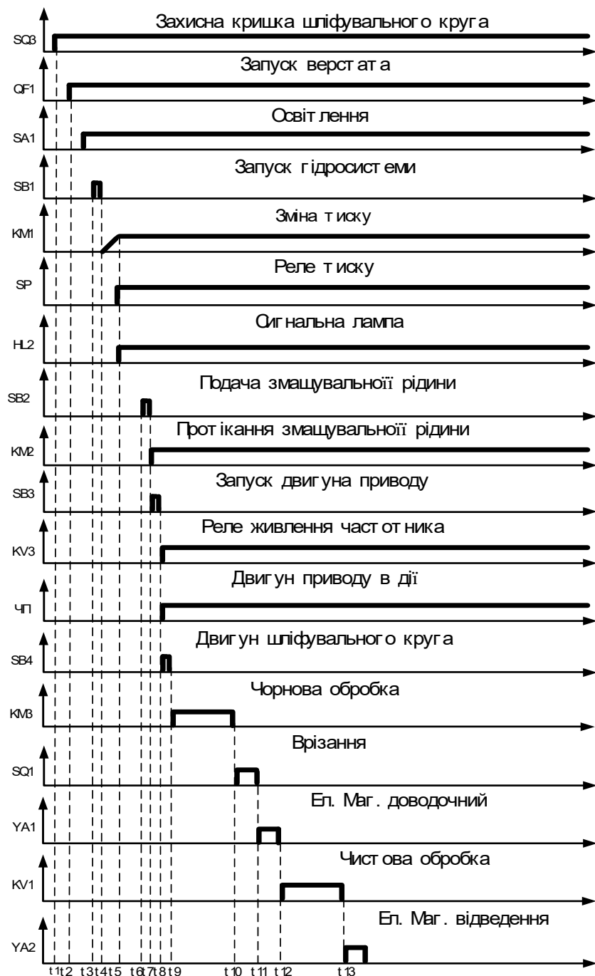
Рисунок 3.6 – Циклограма роботи робочих органів верстата 3А-161
