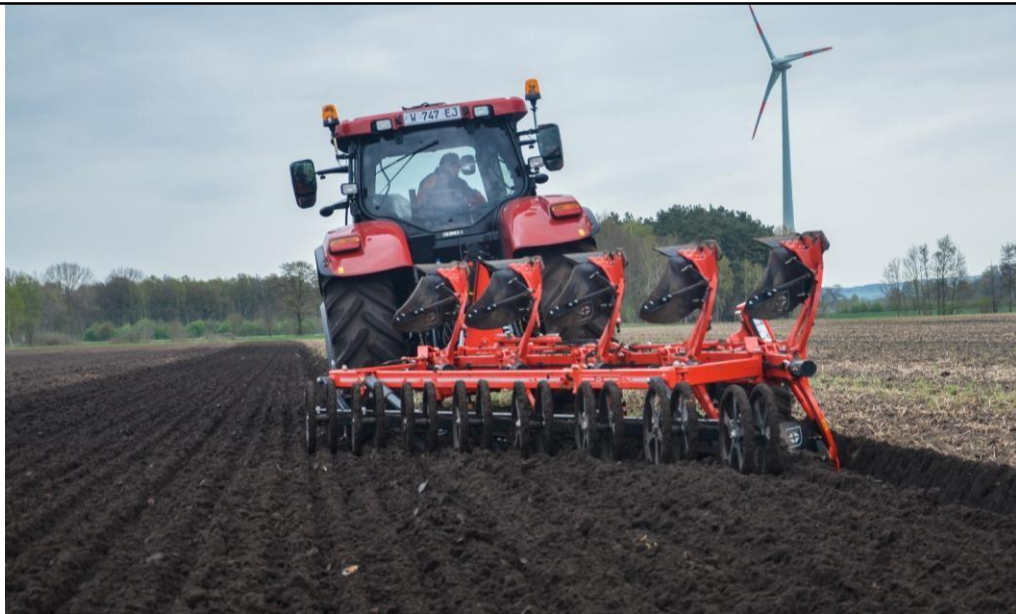
Рис. 3.3 Плуг RW-6 з котком Andrapak виробництва Gregoire Besson
