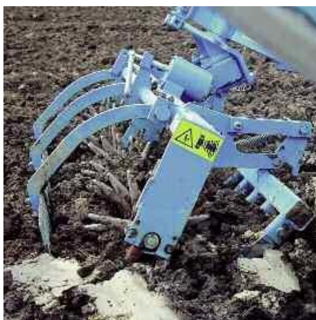
Рис. 3.11 Зірочковий каток FixPack
