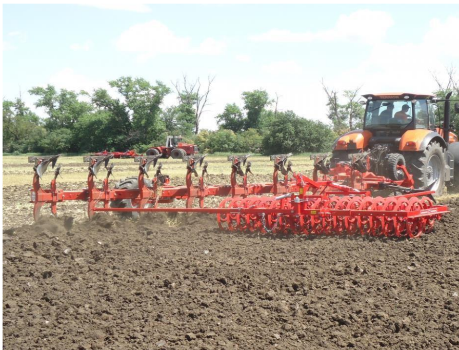
Рис. 3.4 Орний агрегат Gregoire Besson в складі плуга SPB 9 та котка Dura 700
