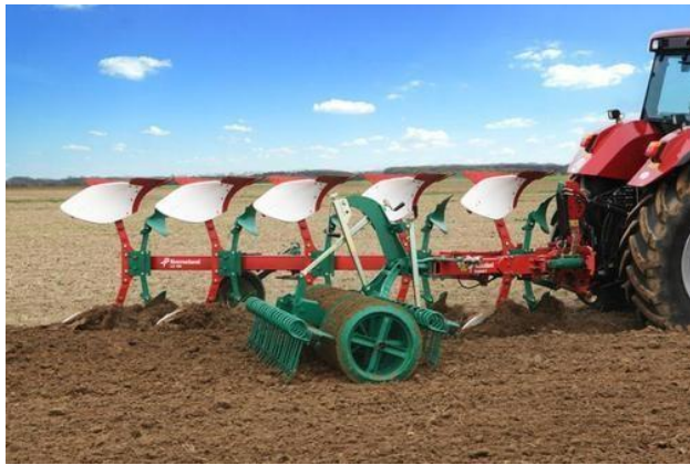
Рис. 3.12 Загальний вигляд плужного агрегату Kverneland з фінішним обладнанням Raskomat
