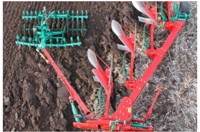
Рис. 3.12 Загальний вигляд плужного агрегату Kverneland з фінішним обладнанням Raskomat
