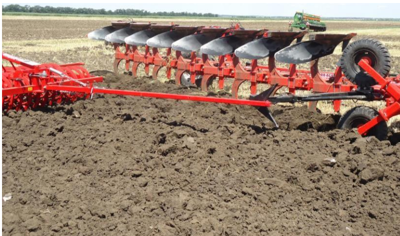
Рис. 3.5 Агрегування котка Dura 700 з плугом
