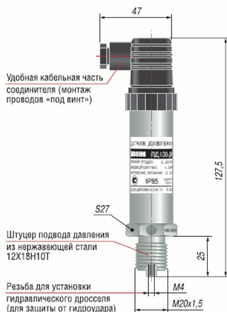
Рисунок 4.1-Загальний вигляд датчика тиску ПД-100ДИ
