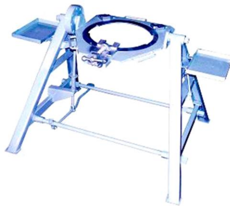
Рис. 3.8 – Стенд для ремонту редукторів задніх мостів
