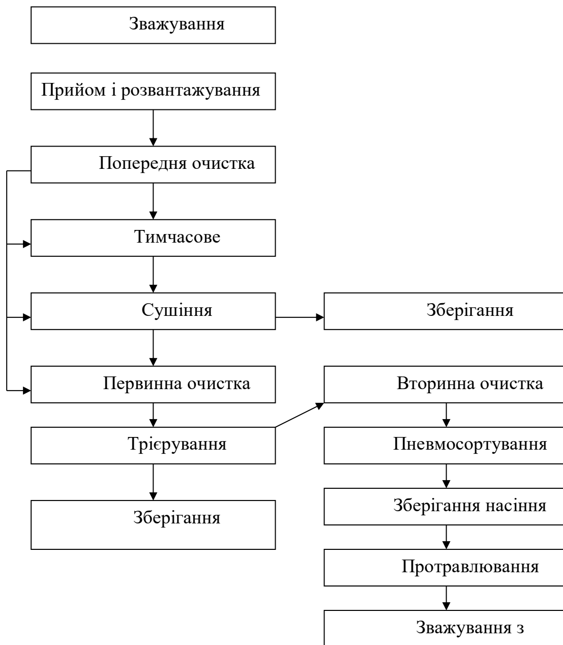
Рисунок 2.1 - Схема технологічного процесу післязбиральної обробки насіння зернових, продовольчого і фуражного зерна.
