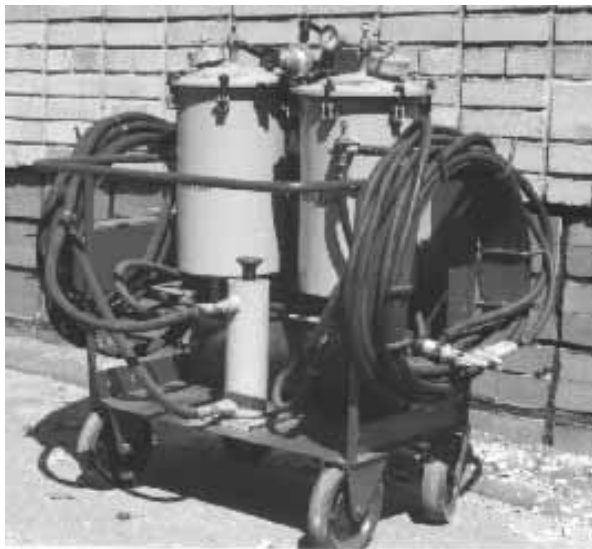
Рис. 2.5 - Начіпна установка УПХН-50: 1 - гідропідйомник; 2 - резервуар для світлозахисного складу; 3 - фільтруюча сітка; 4 - резервуар для консерванту; 5 - пневморедуктор; 6 - ресивер; 7 - розпилювач із насадкою
