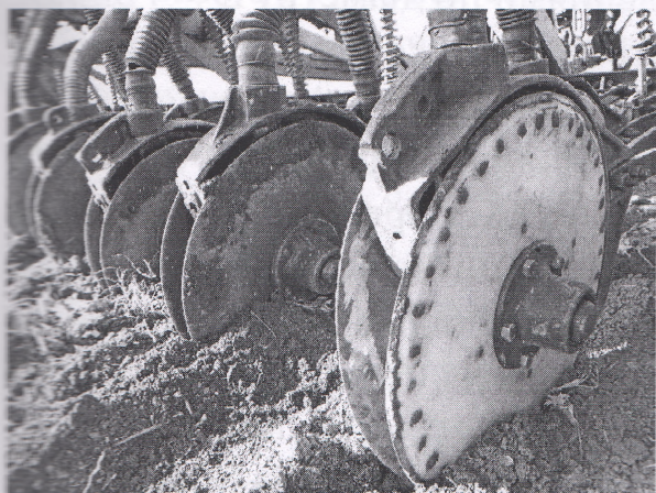
Рис. 5 Вид модернізованого та стандартних широкорядних (однорядкових) сошників сівалки СЗ-3,6 після польових випробувань
