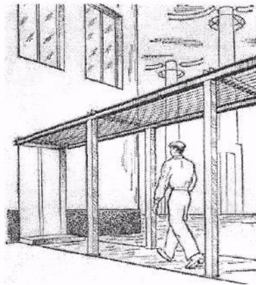
Рис. 4.22. Стационарний екрануючий навіс над проходом в будівлю
