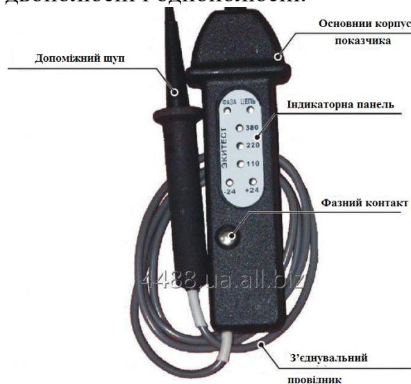
Рис. 4.23. Показчик низької напруги і чергування фаз на напругу 0,4 кВ УННЧФ-0,4
