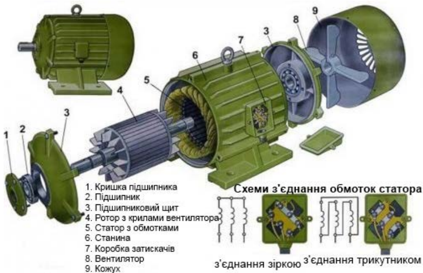
Рисунок 5.5 – Конструкція асинхронного двигуна
