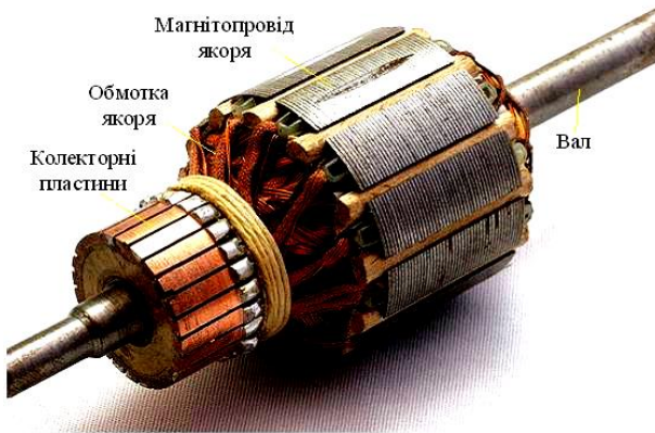
Рисунок 4.3– Якір двигуна постійного струму
