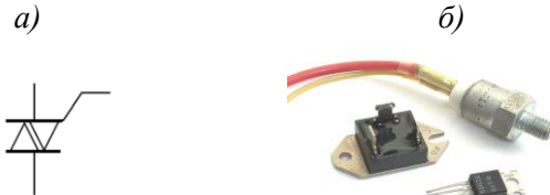
Рисунок 1.27 – Умовно-графічне позначення (а) та зовнішній вигляд симісторів (б)
