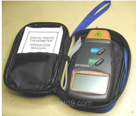
Рисунок 4.37 –Лазерний безконтактний цифровий тахометр DT-2234C+
