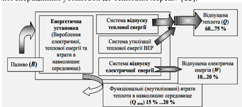
Рисунок 6.16 – Структура енергетичної складової когенераційної установки
