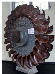
Рисунок 3.5 – Турбіна Пелтона: a – умовний вигляд; б – робоче колесо
