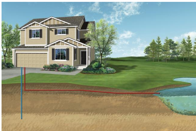
Рисунок 5.12 – Теплова помпа “вода-вода” з використанням ґрунтових вод
