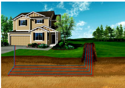
Рисунок 5.9 – Геотермальний насос “ґрунт-вода” із земляним контуром
